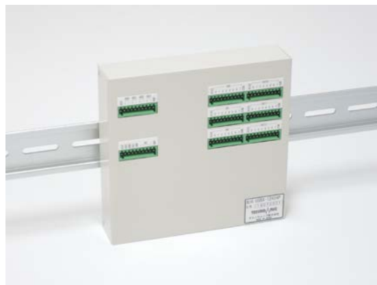
図 10 DIN レールへの固定
