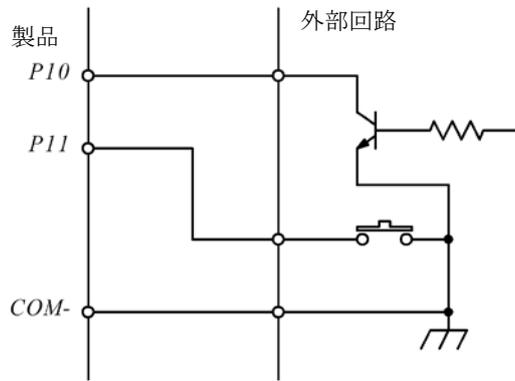
図 23 USBX-I16P 絶縁入力端子の接続例
