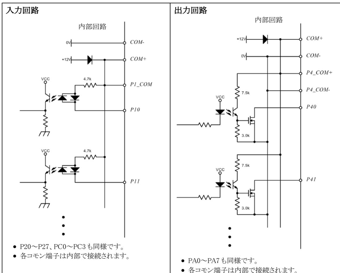
図 22 USBX-I16P の絶縁入出力回路
