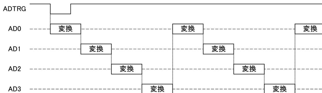
図 41 USBM\_ADCopy() の変換の様子
