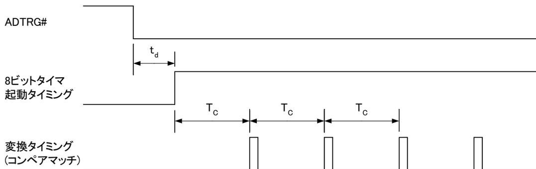
図 40 `USBM_ADStart()` の `Trig` 指定時の変換タイミング
