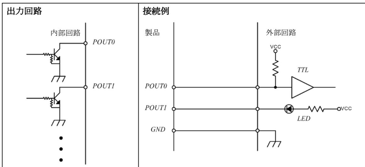
図 27 非絶縁出力回路と接続例
