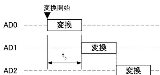
図 38 複数チャンネルの AD 変換の様子
