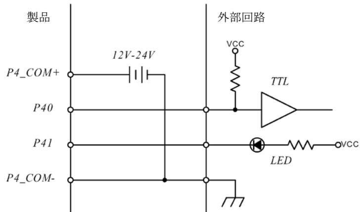
図 21 USBX-I16 絶縁出力端子の接続例
