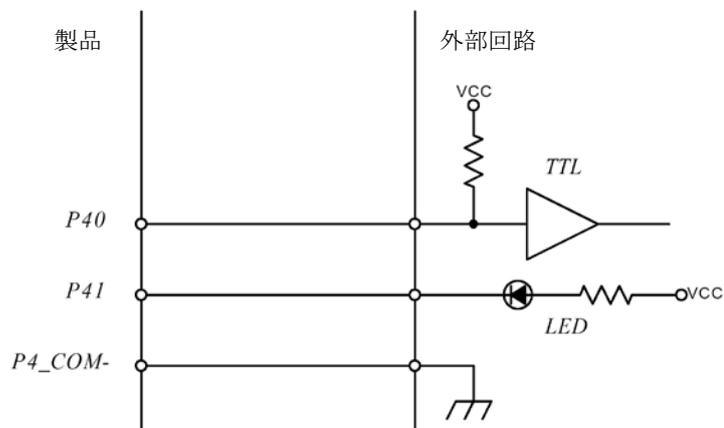
図 25 USBX-I16 絶縁出力端子の接続例
