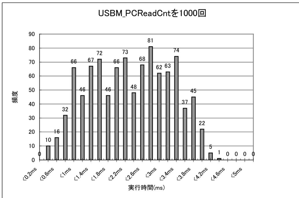
図 47 `USBM_PCReadCnt()` を 1000 回実行したときの応答時間の分布
