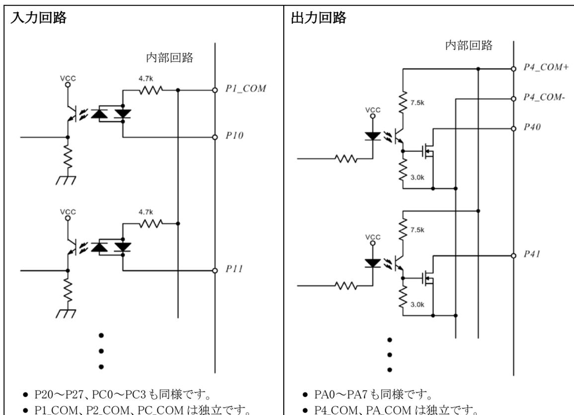
図 19 USBX-I16 の絶縁入出力回路
