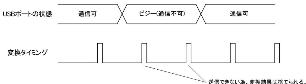
図 39 AD 変換結果の送信不能状態
