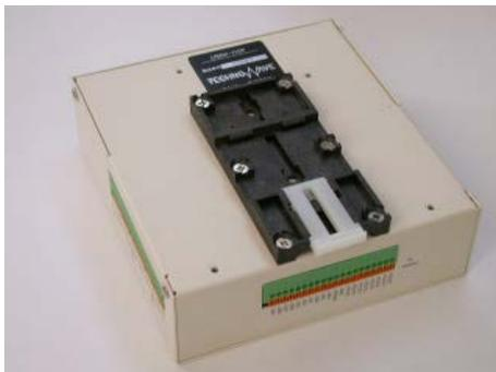
図 2 DIN レール取付具の固定
