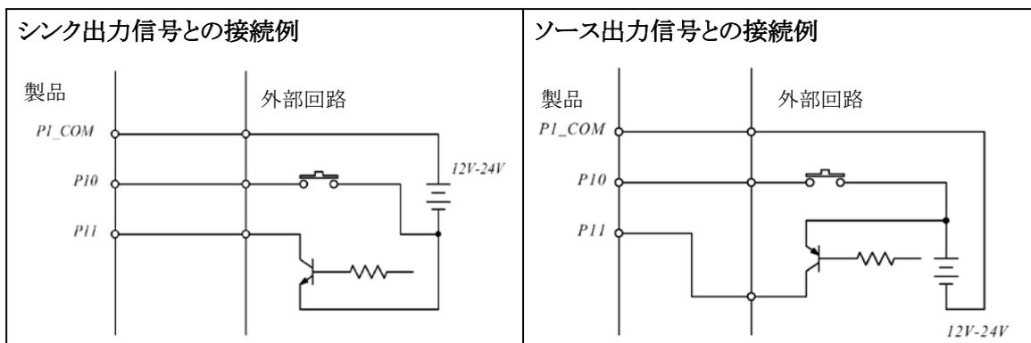
図 20 USBX-I16 絶縁入力端子の接続例
