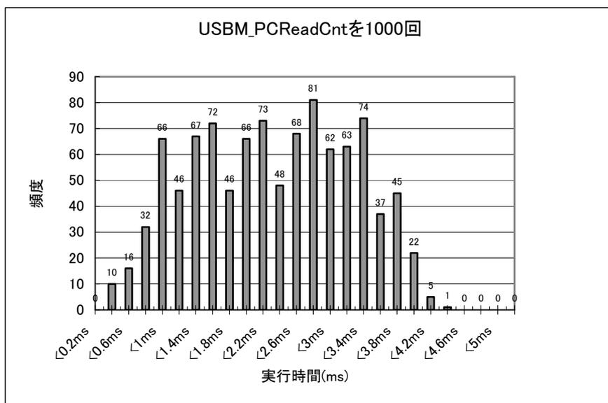
図 42 `USBM_PCReadCnt()` を 1000 回実行したときの応答時間の分布
