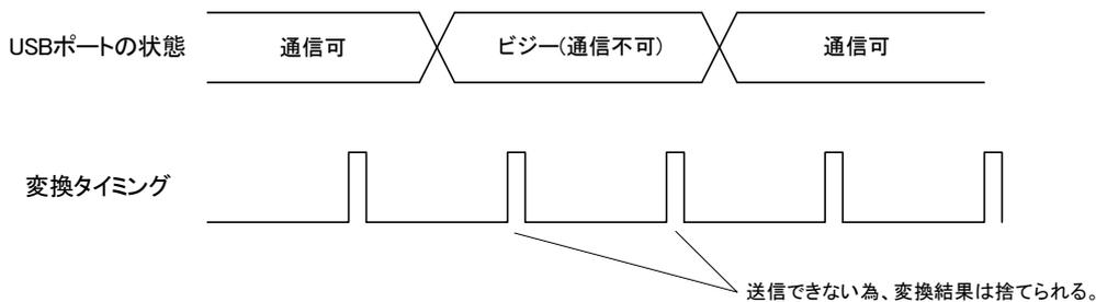
図 29 AD 変換結果の送信不能状態
