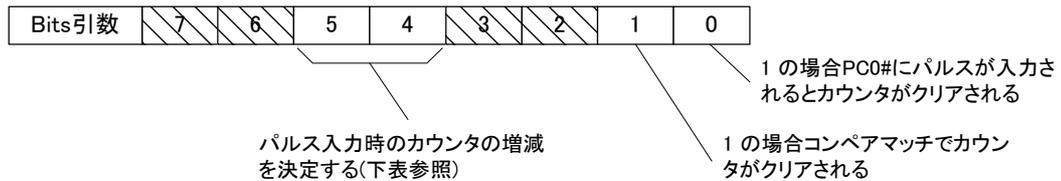
図 36 `USBM_PCSetControl()` の `Bits` 引数
