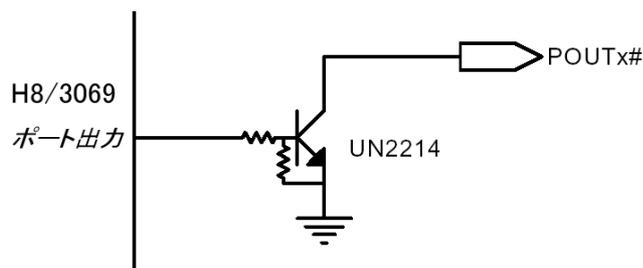
図 22 POUTx#端子の出力回路
