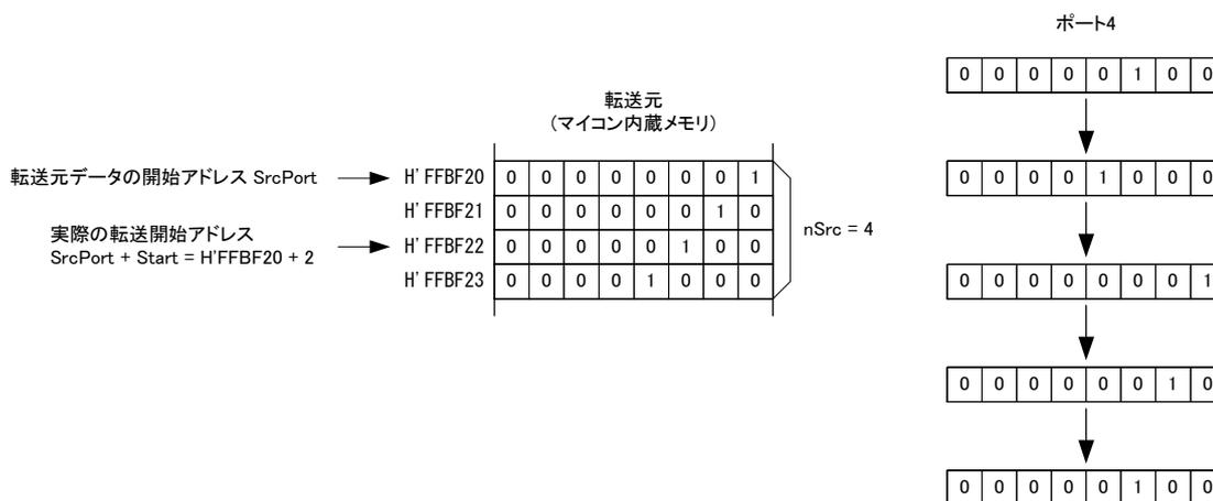
図 41 `USBM_TCPYSetPatternCtrl()` の設定例
