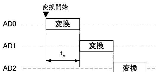
図 28 複数チャンネルの AD 変換の様子
