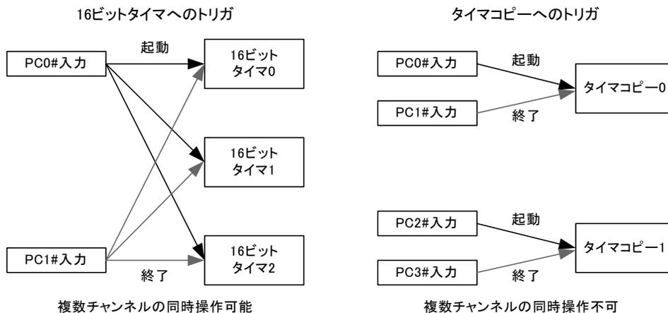
図 39 パルスカウンタ入力による 16 ビットタイマとタイマコピーの操作
