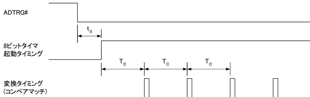
図 30 `USBM_ADStart()` の `Trig` 指定時の変換タイミング
