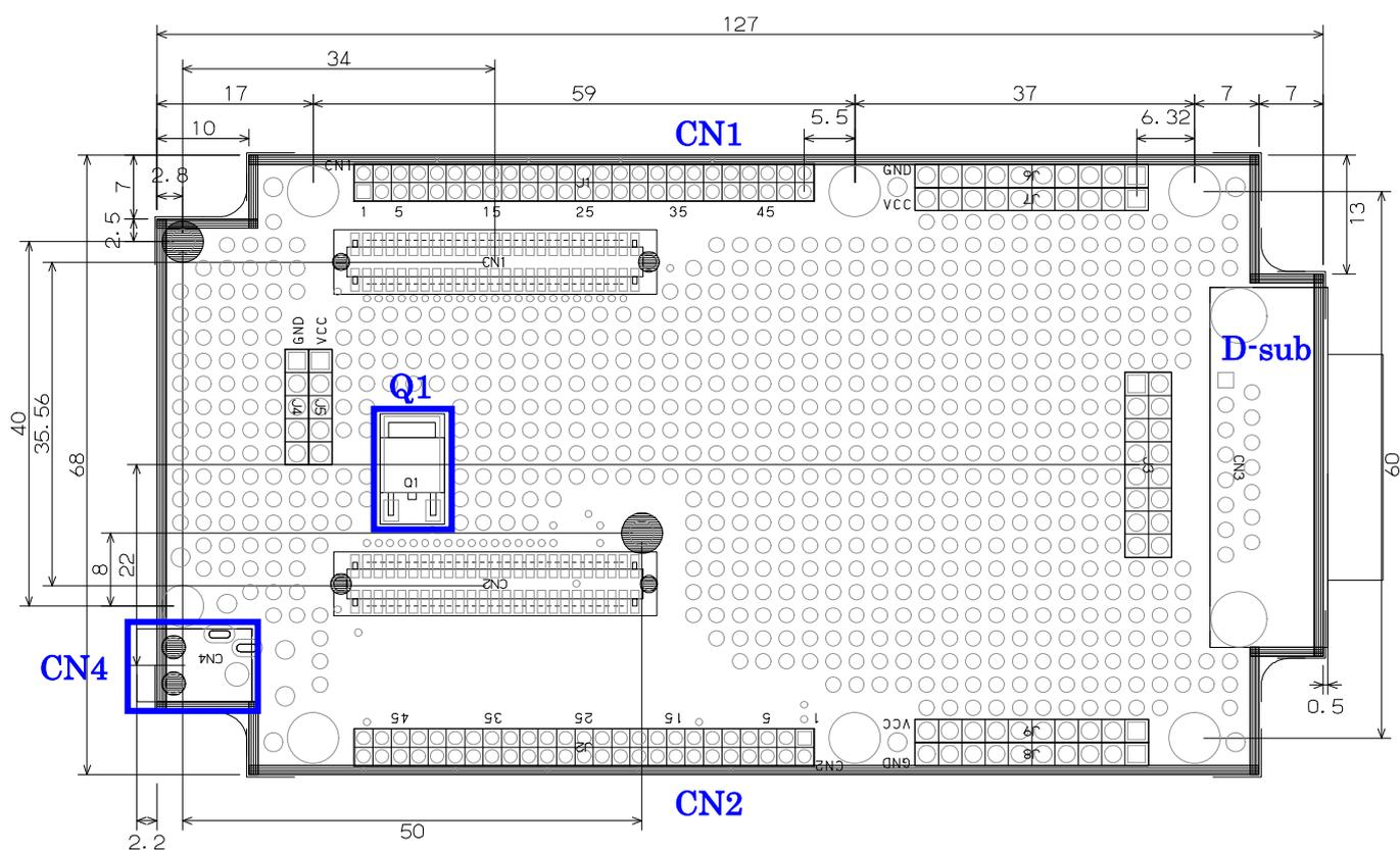
図 1.M3069S ユニバーサルボード寸法図
