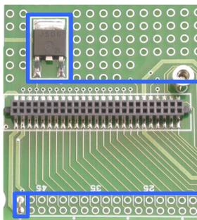
Q1 に付属の FET トランジスタを実装し、CN2-49 と CN2-50 をジャンパー線等で接続してください。
