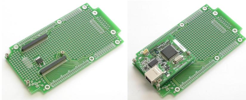
図 2.マイコンボードの取り付け
