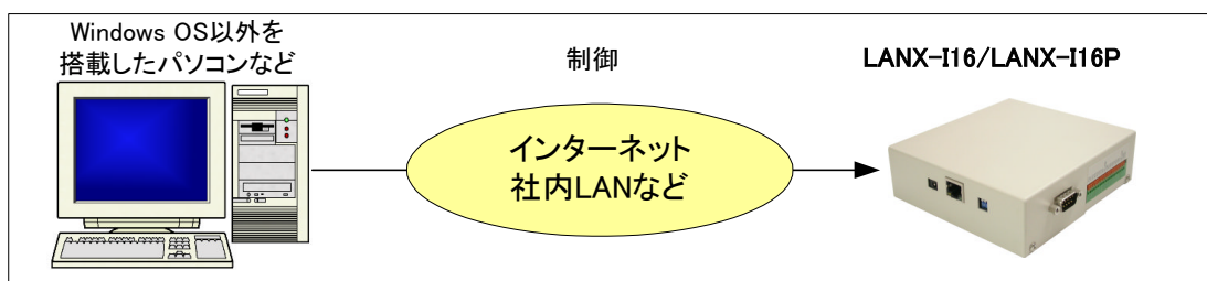
図 1 バイナリコマンド・ファームウェアを用いた制御
