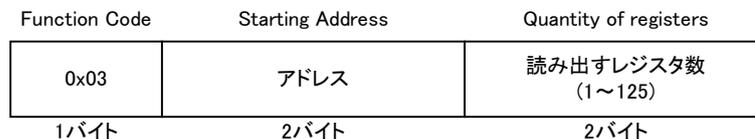
図 7 Read Holding Registers リクエストの PDU
