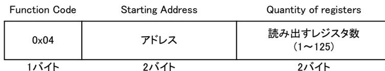
図 11 Read Input Registers リクエストの PDU
